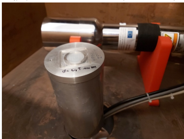
Rys. 2.5.2. Detektor HPGe oraz scyntylator NaI wchodzące w skład układu antykoincydencyjnego.
