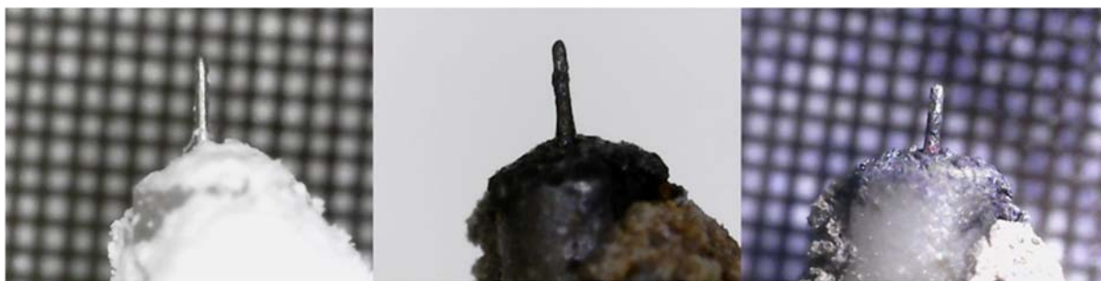
Rysunek 19. Sonda Langmuira na początku eksploatacji (z lewej), po pierwszych testach gdy utknęła w kanale na kilka sekund na skutek złego działania manipulatora (po środku) oraz po zakończeniu testów (z prawej).
