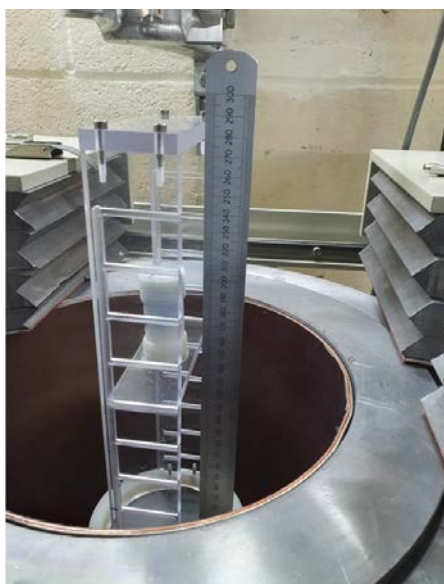
Rys. 2.4.3: Geometria pomiaru próbek napromieniowanych w zakończeniu aktywacyjnym KN2 6U.
