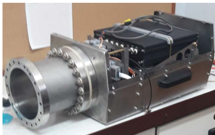
Rys.1.1.17 Nowy moduł „detector box” wraz z umieszczonym w nim cyfrowym analizatorem amplitud.
