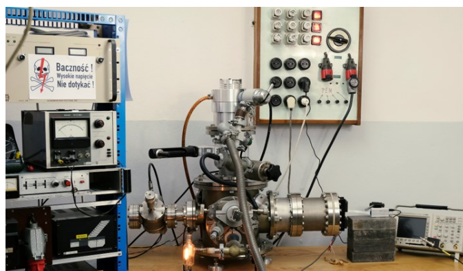
Rys.1.1.16 Stanowisko testowe do testowania i kalibracji nowych detektorów przy pomocy lampy rentgenowskiej.
