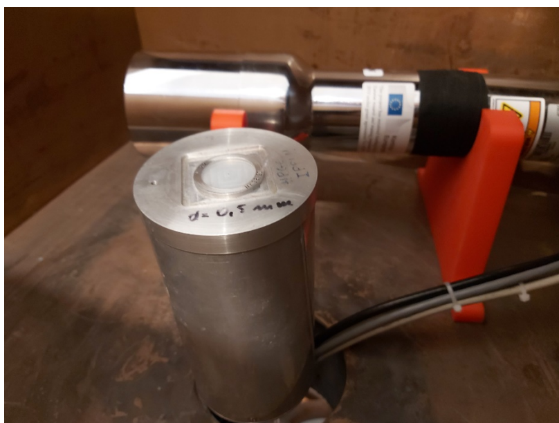
Rys. 2.4.2: Detektor HPGe oraz scyntylator NaI wchodzące w skład układu antykoincydencyjnego.
