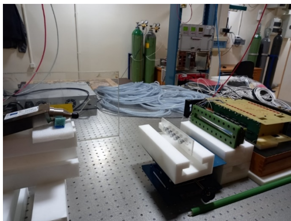
Rys. 4.175 System detektora GEM wyposażony w źródła promieniowania Fe i lampę Amptek Mini-X.
