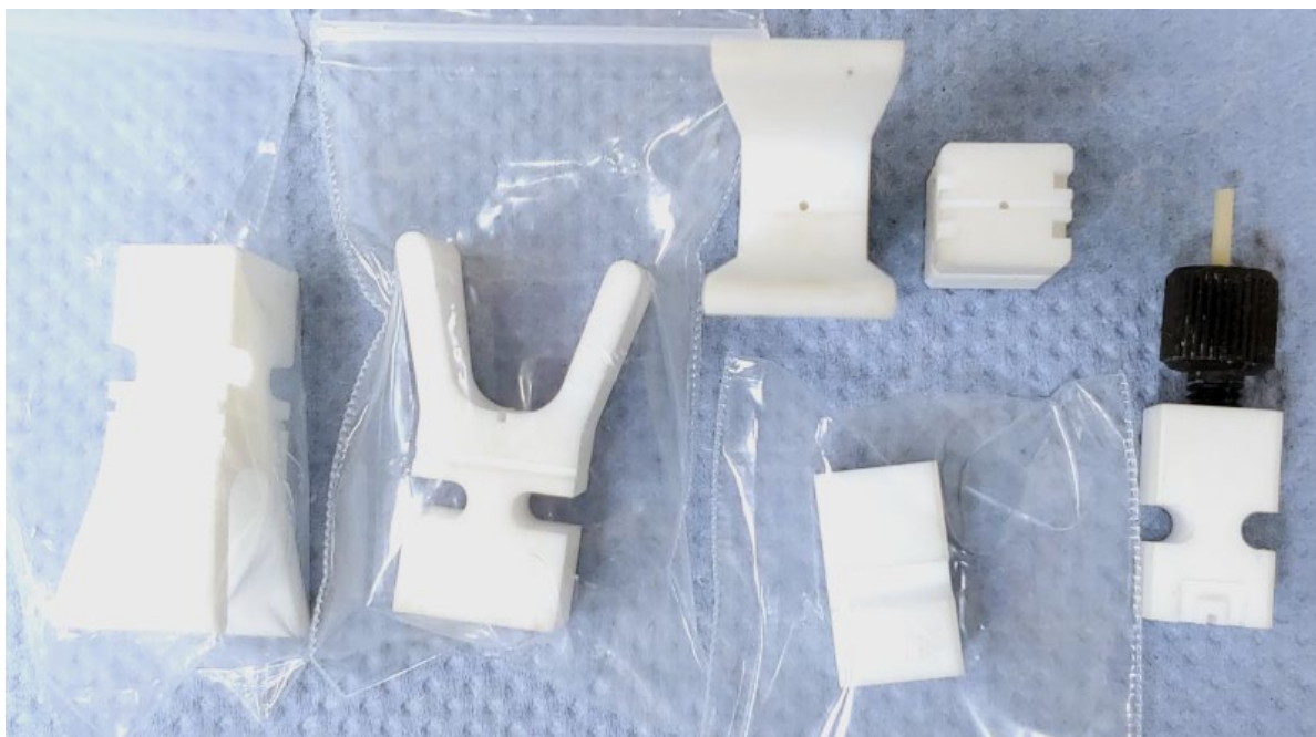
Rys. 6.1.7. Dwa warianty dystrybutora z Macoru: „skrzydełka” mają osłaniać baterię przed potencjalnymi wyciekami PTFE. Na środku rowka plenum paliwowego widoczny otwór kapilarny dostarczający paliwo. Z prawej strony pokazano dystrybutor połączony z kapilarą z wykorzystaniem uszczelnienia typu „ferulla”
