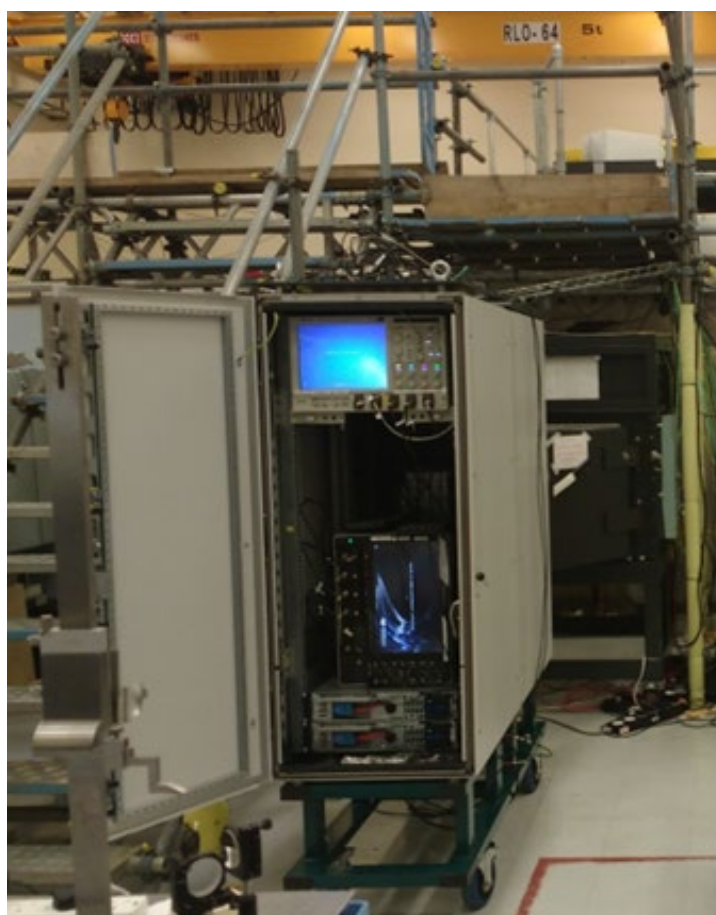
Rys. 2.4.5.3. Klatka Faradaya chroniąca przed zakłóceniami oscyloskopy używane do pomiarów w eksperymencie
