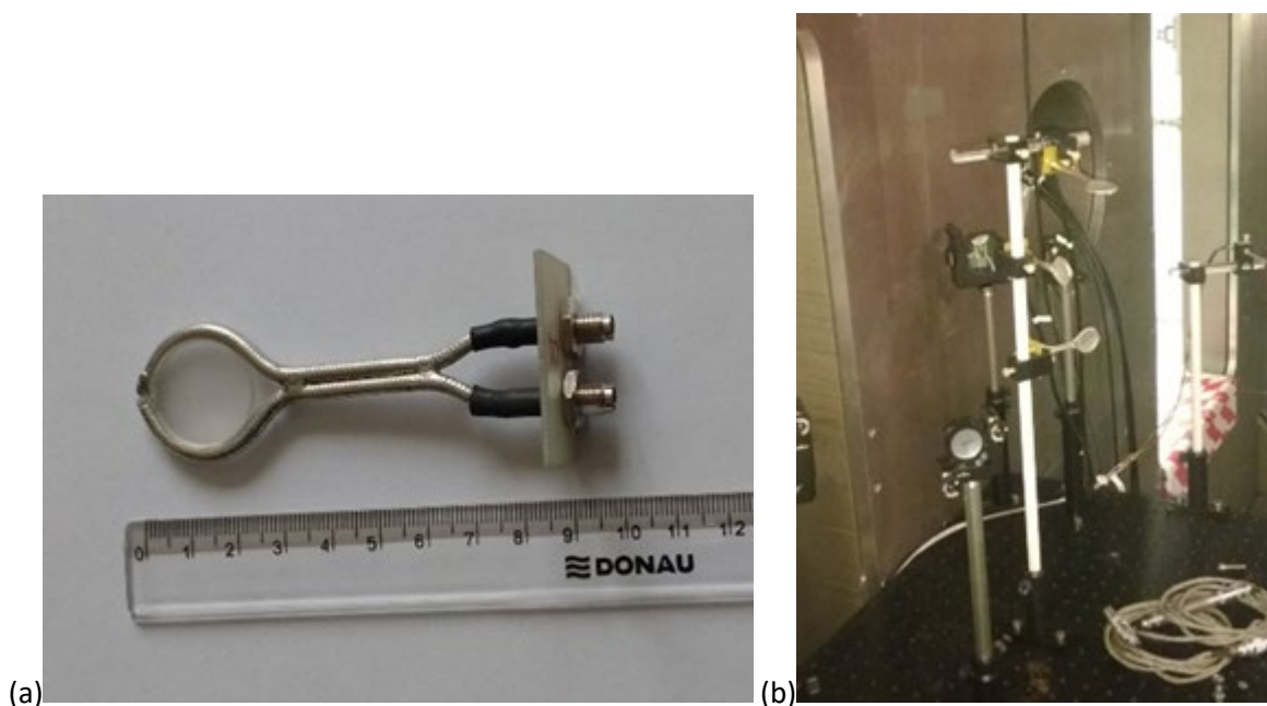
Rys. 2.4.3.1. (a) Sonda pętlowa o topologii Moebiusa ze złączem SMA, skonstruowana w IFPiLM. Pętla sondy ma średnicę ok. 2,5 cm. (b) Zdjęcie trzech sond pętlowych skonstruowanych w IFPiLM, zainstalowanych w komorze doświadczalnej lasera Vulcan PW. Sondy są zamocowane w dielektrycznych uchwytach w taki sposób, aby rejestrować jednocześnie w zbliżonym położeniu trzy ortogonalne składowe pola magnetycznego
