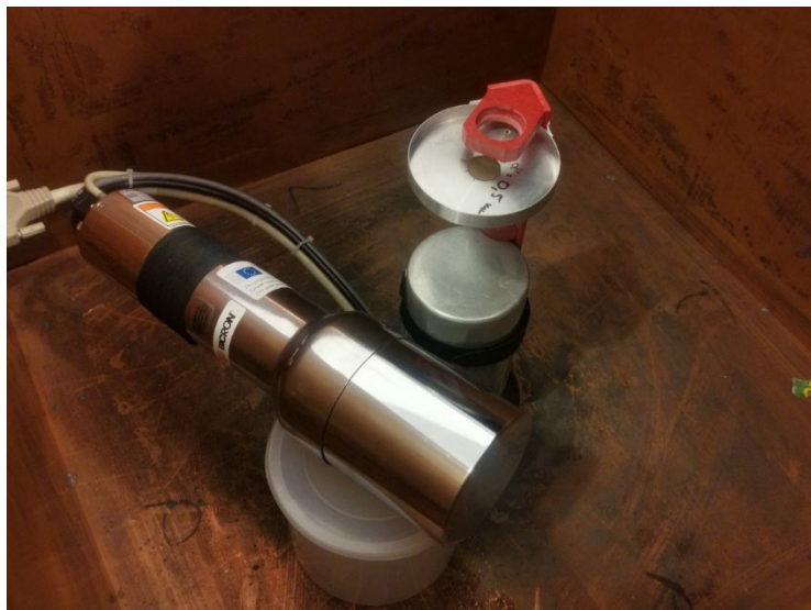
Rys. 2.5.4. Konfiguracja pomiarowa dla próbek materiałów ITER zaaktywowanych w trakcie kampanii C40b oraz DTE2 na tokamaku JET.
