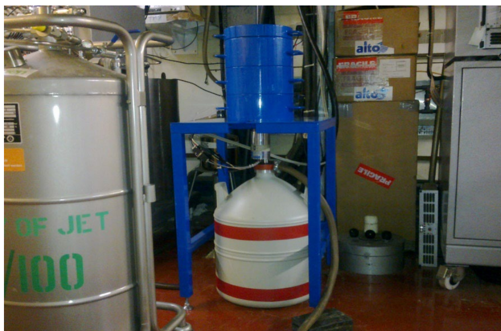
Rys. 2.3.2. Detektor HPGe wraz z osłoną ołowianą zastosowany w analizie.
