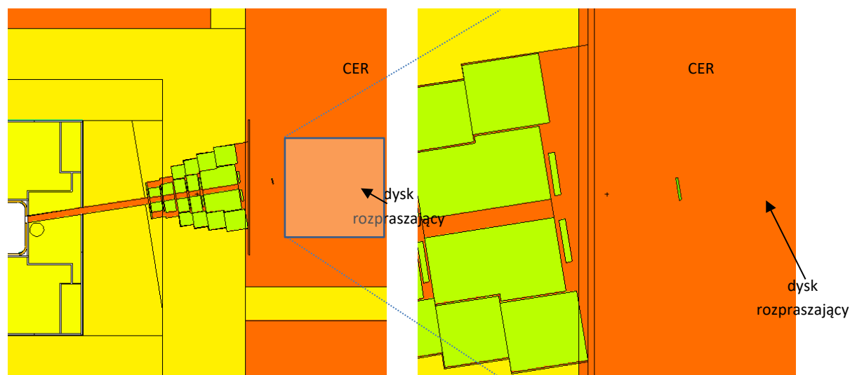
Rys. 2.2.2. Przecięcie pionowe fragmentu modelu TC z zamykaczem wiązki neutronowej i dyskiem rozpraszającym neutrony.
