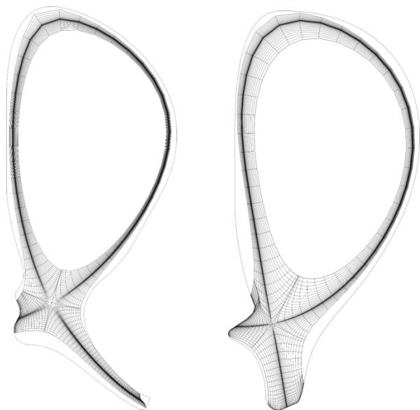
Rys. 3.1.7. Siatka obliczeniowa dla konfiguracji XD (lewy panel) i dla konfiguracji SXD (prawy panel).
