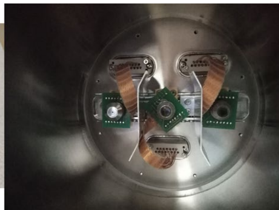
Rys.1.1.17. Ekranowanie 3 kanałów PHA w celu usunięcia zakłóceń podczas działania układu
