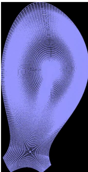
Rys. 5.2.10. Siatka obliczeniowa dla tokamaka ASDEX-Upgrade
