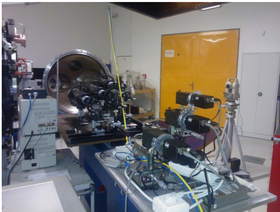
Rys. 2: Widok układu rejestracja 3-kadrowego kompleksowego interferometru zainstalowanego na eksperymencie PALS.
