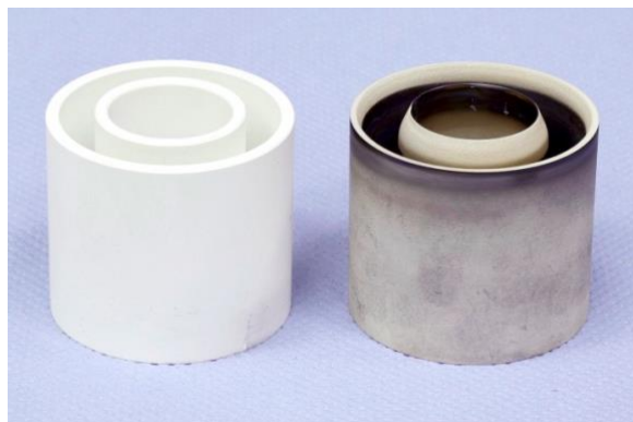
Rys. 20. Erozja ścian izolatora standardowego:
