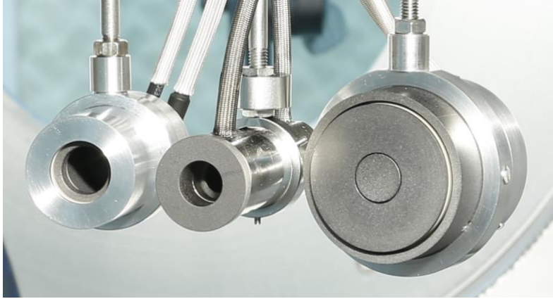
Rys. 7. Jonowe sondy Faraday'a zamontowane w komorze próżniowej na ramieniu manipulatora: w środku pierwsza wersja kolektor kolimującego, z lewej wersja druga, z prawej sonda płaska Faraday'a z pierścieniem ochronnym
