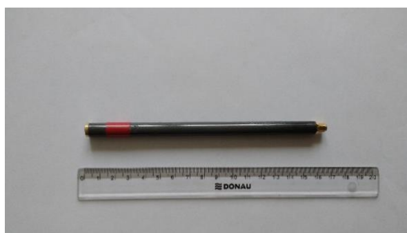
Rys. 3. Antena promieniowania mikrofalowego z pasmem 2-10 GHz
