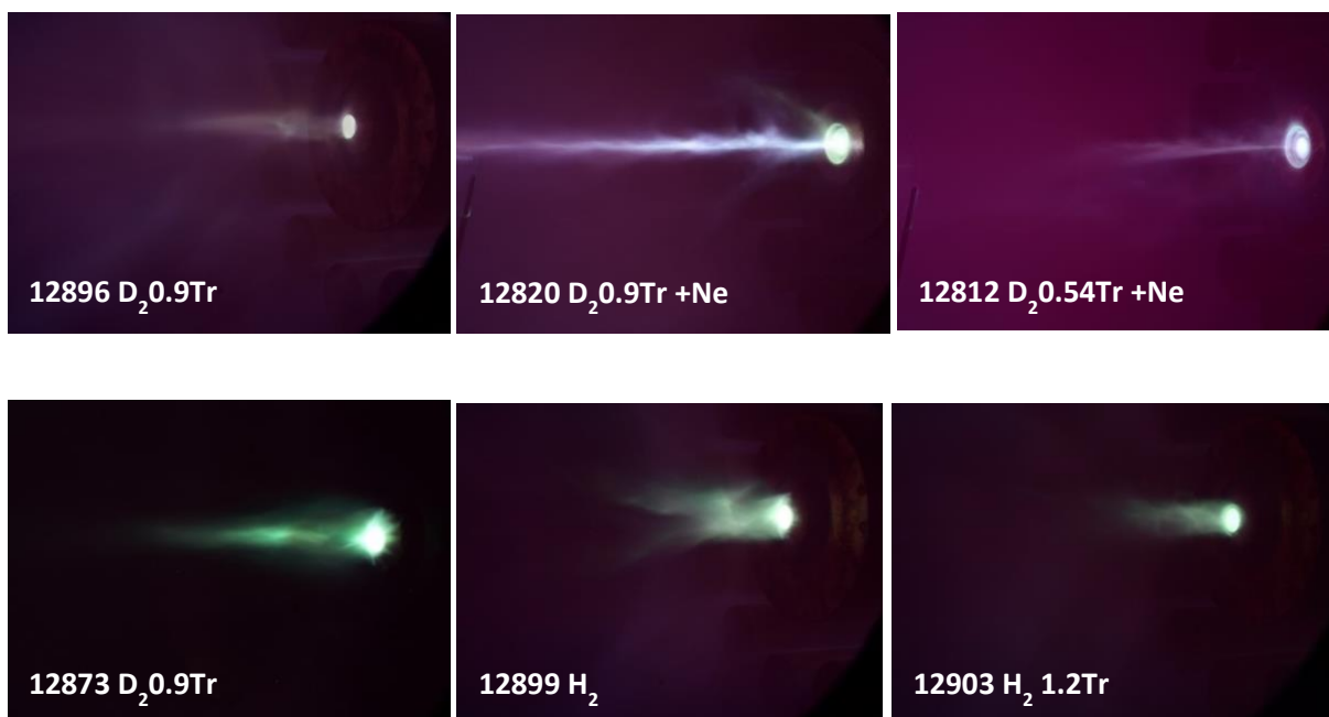
Rys. 8. Integralne obrazy swiecenia plazmy zarejestrowane w roznych warunkach gazowych w komorze.
