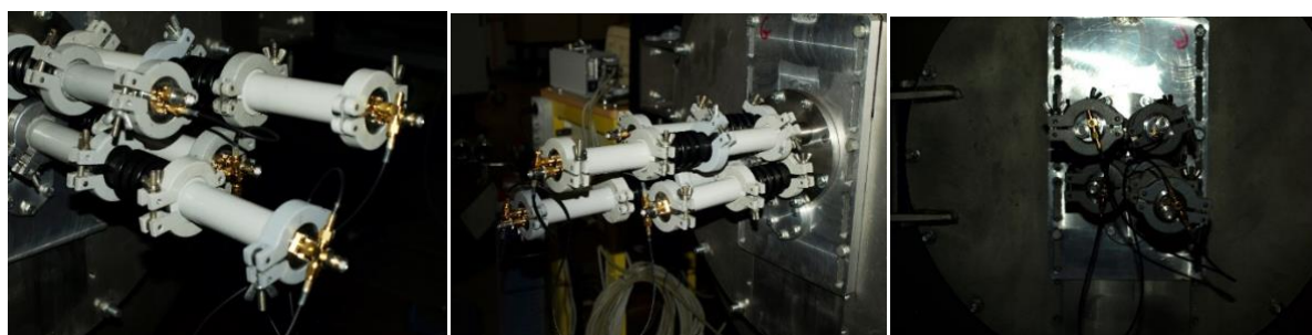
Rys. 3. Widok systemu czterech pin diod zainstalowanych na osi urządzenia PF-1000U.
