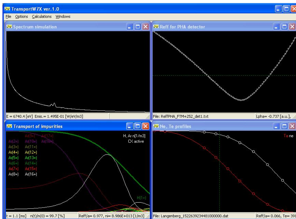
Rys. 1.1.17. Interfejs użytkownika dla kodu TransportW7X - główne okna danych wyjściowych (widmo, linia widzenia detektora, gęstość jonów, profile TS).
