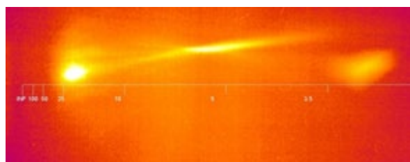
Rys. 13. Widmo energetyczne elektronów dla profilu o dużej długości
