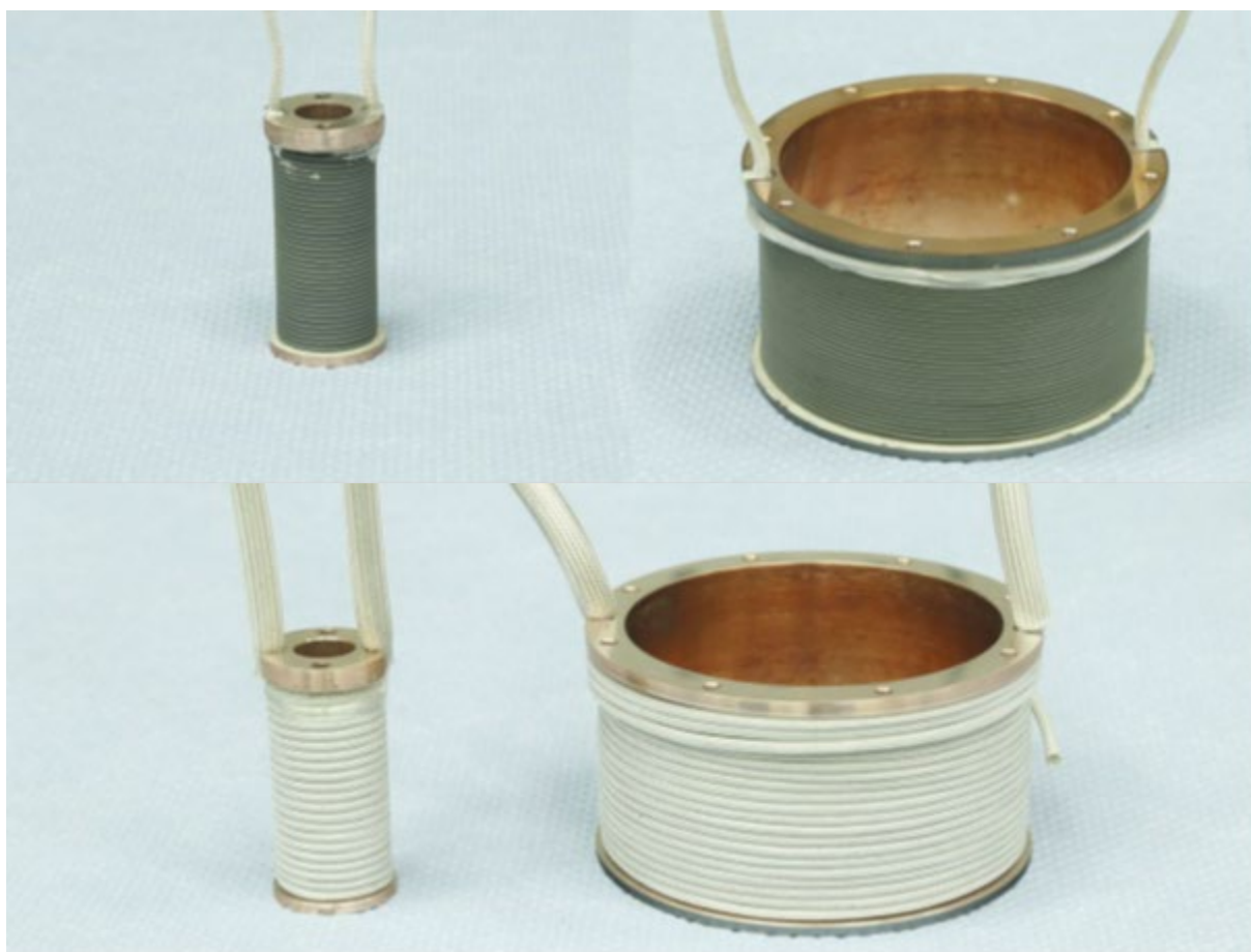
Rys. 3. Uzwojenia silnika KLIMT (górny panel) oraz ich modyfikacja dla wersji kick-off silnika HIKHET
