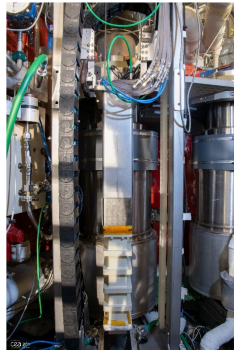
System detekcji zainstalowany w porcie pionowym tokamaka WEST
