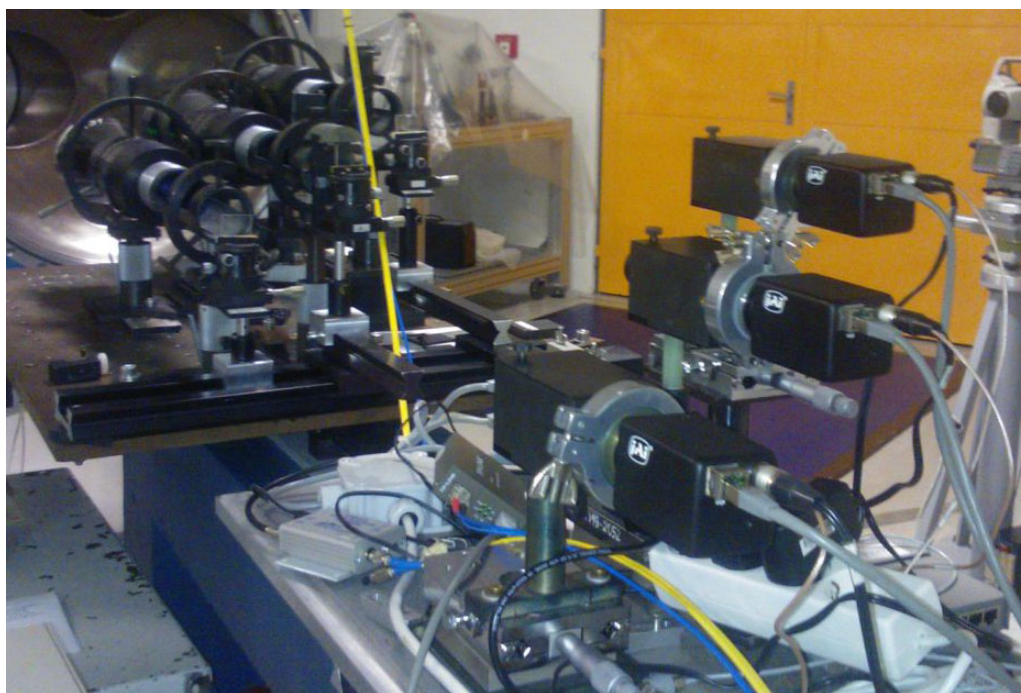
Rys. 6.2.6 Widok układu rejestracji 3-kadrowego interferometru zainstalowanego na PALS
