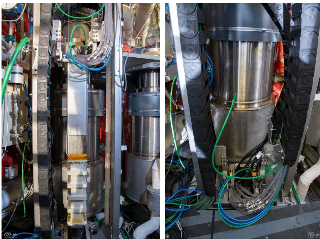
Rys.1.3.3. Zdjęcia pokazujące system detekcji miękkiego promieniowania X oparty o detektor gazowy GEM (z wyjątkiem elektroniki do procesowania danych) nad portem (po lewej) i w porcie (po prawej).
