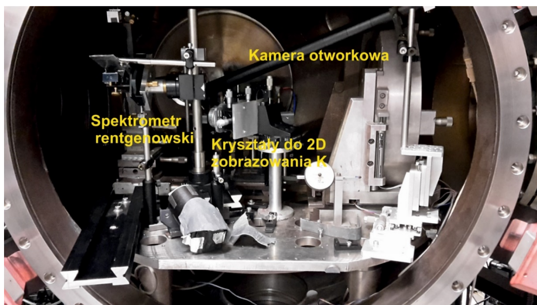
Rys. 6.2.2 Widok aparatury spektroskopowej zainstalowanej w komorze eksperymentalnej.
