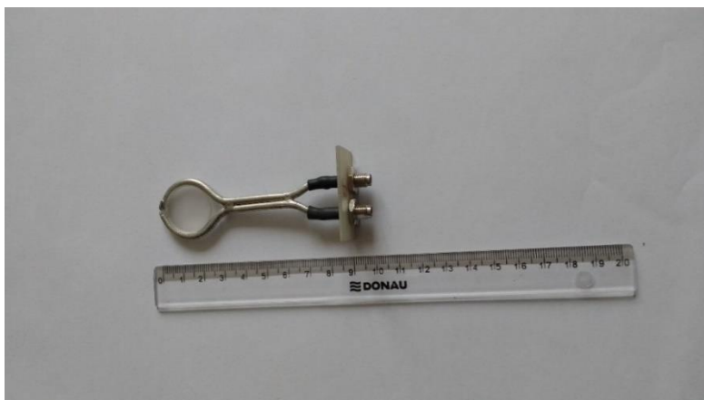
Rys. 3 Sonda B-dot w postaci pętli o topologii Moebiusa, wykonana w IFPiLM
