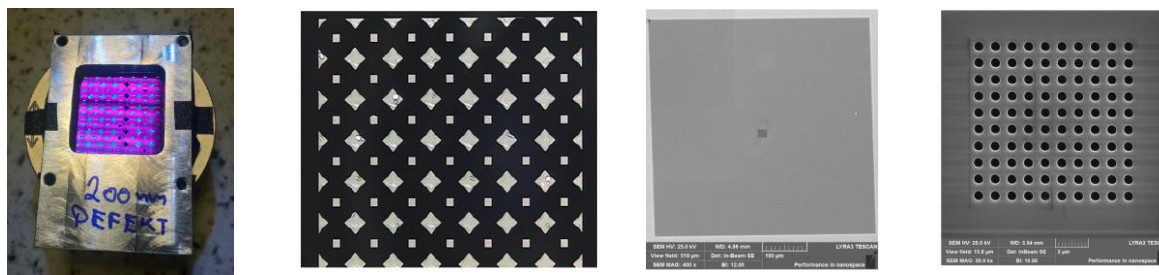
Rys. 7. Konstrukcja tarczy typu Hollow; w powiększeniu od lewej do prawej
