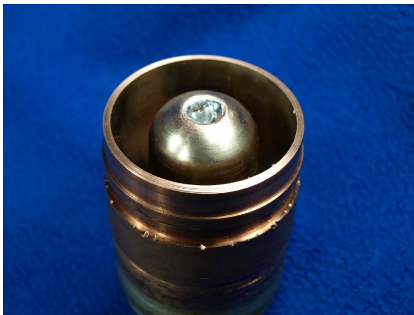
Rys.1. Uszkodzona głowica generatora PF-6 po odcięciu pokrywy. Widoczna erozja czoła anody.
