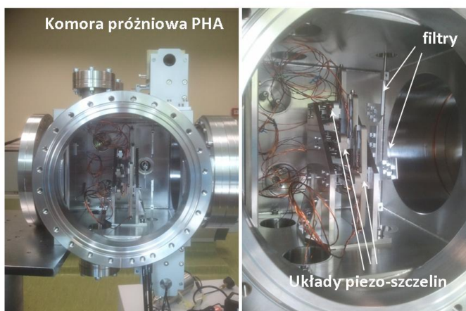
Rys.1.1.3 Zdjęcia wnętrza komory próżniowej diagnostyki PHA z widocznymi zainstalowanymi układami piezo-szczelin oraz uchwytami dla filtrów.
