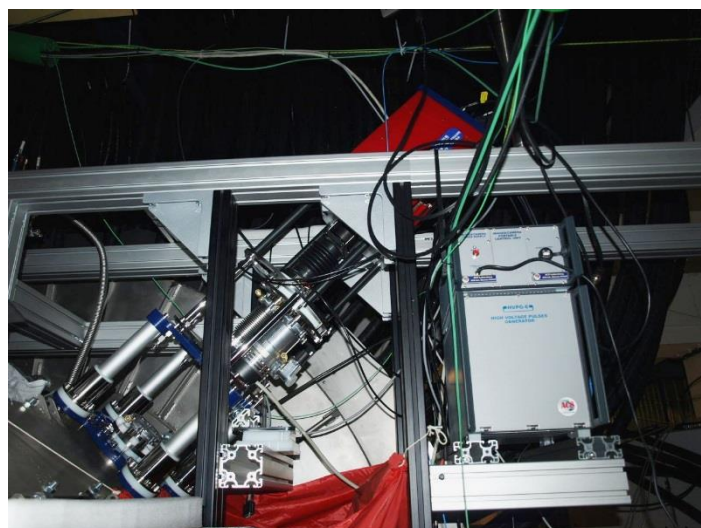
Rys.1.9 Kamera do rejestracji obrazów zamontowana na komorze generatora plazmy PF-1000.
