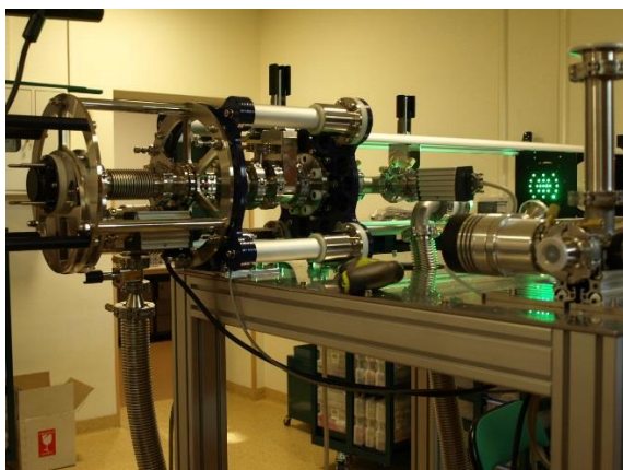
Rys.1.8 Kamera do rejestracji obrazów plazmy na stanowisku testowym.
