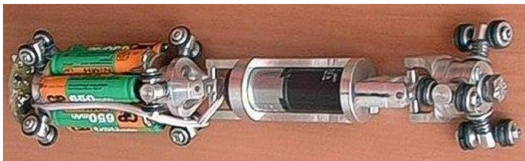
Robot D-40 proponowany, jako urządzenie przemieszczające kapsułę ze źródłem promieniotwórczym.
