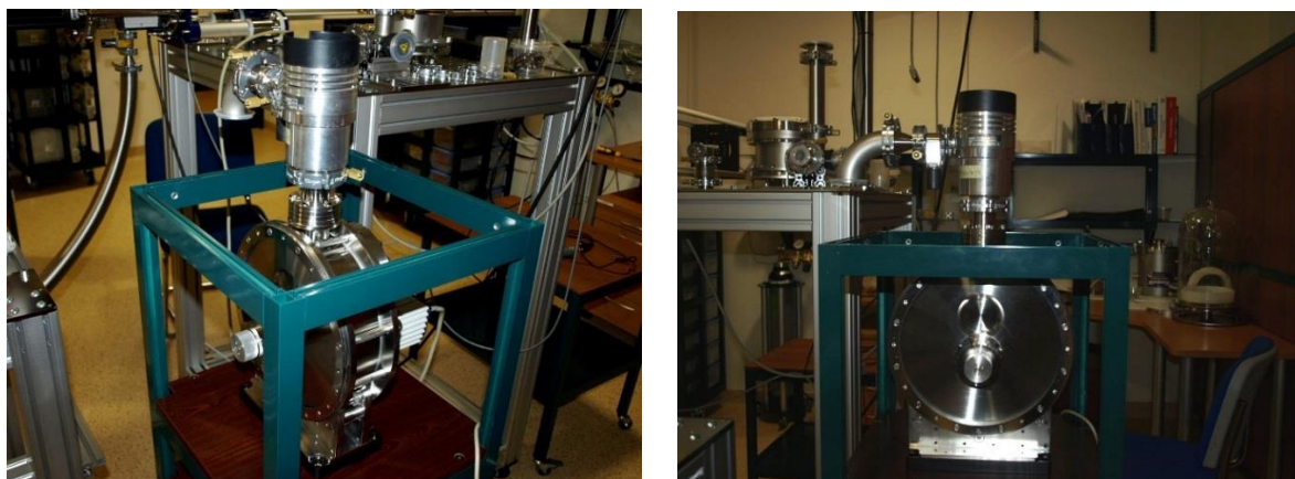
Rys.2.11 Widok specjalnego stanowiska do testowania detektora neutronów opartego na Open-MCP.
