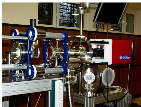
Rys.1.8 Kamera do rejestracji obrazów plazmy na stanowisku testowym.
