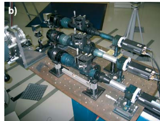
Rys. 1 - Trzy-kadrowy interferometr a) schemat optyczny oraz b) widok układu rejestracji interferometru 3-frame interferometer a) optical scheme and b) the view of the registration system of the interferometer
