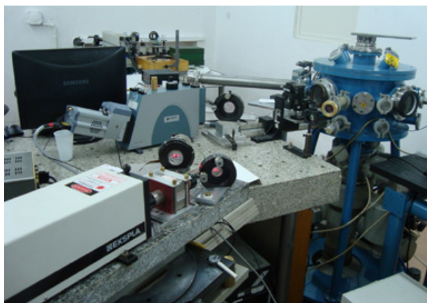
Fot. 6. Układ eksperymentalny do badania laserowego usuwania kodepozytu z płytek wyjętych z komory tokamaka
