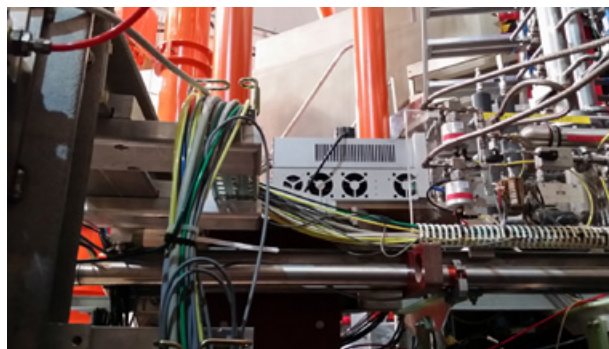
Fot. 5. Gazowy detektor GEM zbudowany w IFPiLM zainstalowany na tokamaku ASDEX UG w Garching, Niemcy
