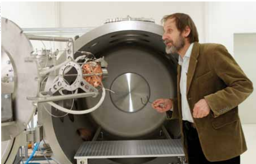
Dr Jacek Kurzyzna – twórca laboratorium PlanS podczas pracy przy montażu silnika Halla
