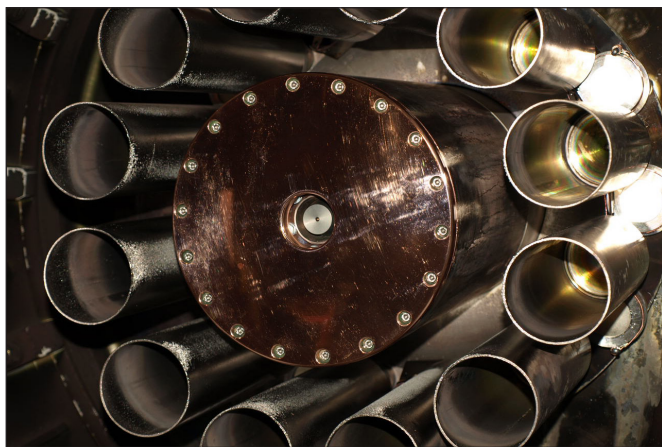
Elektrody układu PF z systemem dynamicznego napuszczania gas-puff
