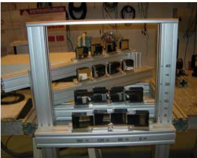
Zwierciadła wprowadzające impulsy laserowe w obszar plazmy
