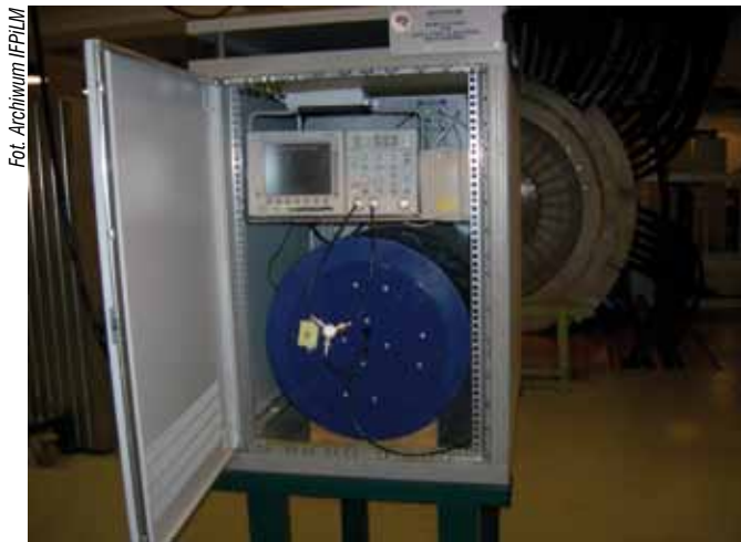
Zestaw pomiarowy z sondą scyntylacyjną typu BRAVO w mobilnej klatce
