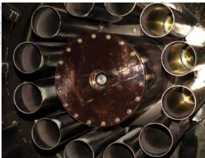
Elektrody układu PF – z systemem dynamicznego napełniania gas-puff
